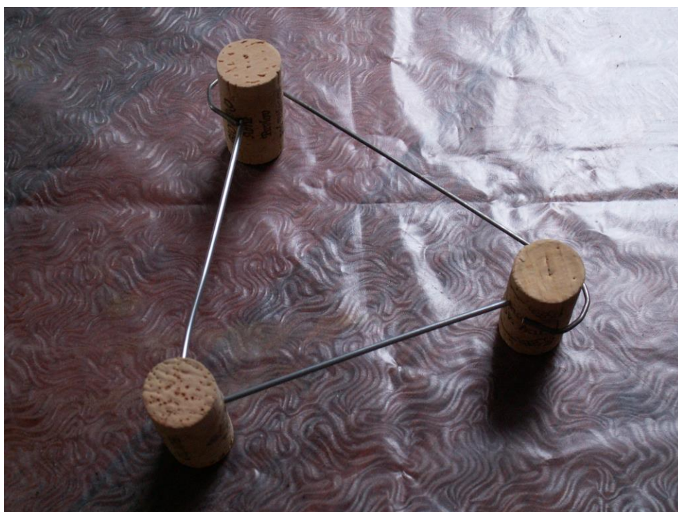
Improvizovaný držák na baňku z korkových špuntů a ocelového drátu.
